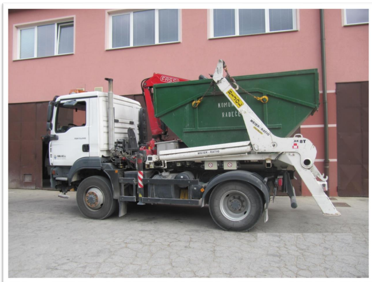
Slika 3: Vozilo za kontejnerski odvoz in praznjenje ekoloških otokov MAN
